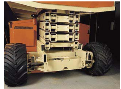
Arm Stack Diperkuat untuk Kekakuan Tumpukan yang Lebih Baik
