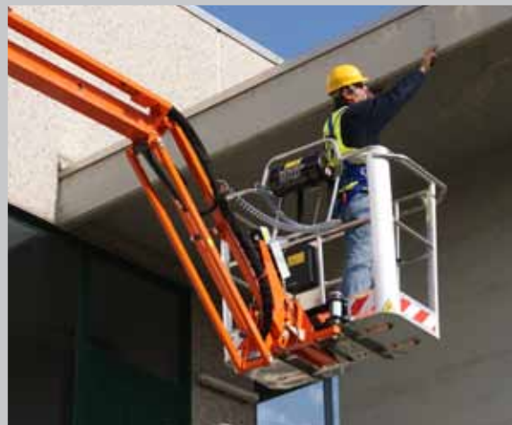
Fungsi jib dengan penginderaan (sensing) beban otomatis
