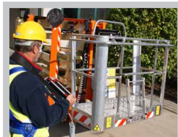
Kotak kontrol jauh (dengan kabel 3 m)
