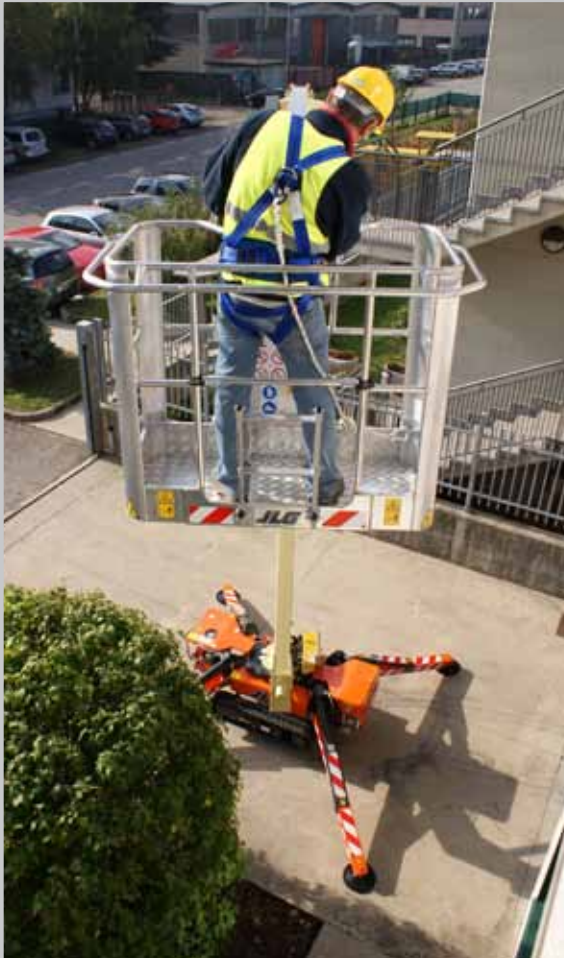
Pola outrigger segi empat untuk menambah stabilitas
